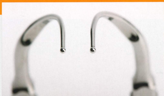
figuur 16 Ultrasonie tips (EMS: PL4, PL5) die de vorm hebben van een furcatie-sonde met aan het einde een bolletje met een diameter van 0.8mm. Dit heeft als doel het oppervlak ter plaatse van het puntje van de tip te vergroten.
