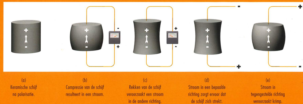
figuur 6 Activiteit van een piëzo-elektrisch element.
