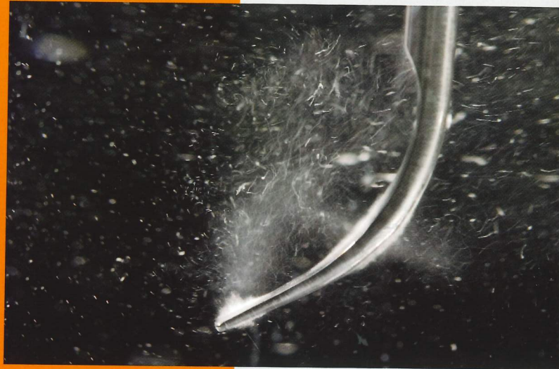
figuur 9 Cavitatie effect (belletjes) en microstroming die optreden als een geactiveerde ultrasoon tip in een vloeistof wordt ondergedompeld.
