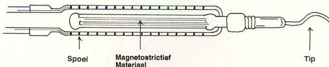
Afb. 1. Doorsnede handstuk van de ultrasone apparatuur.
